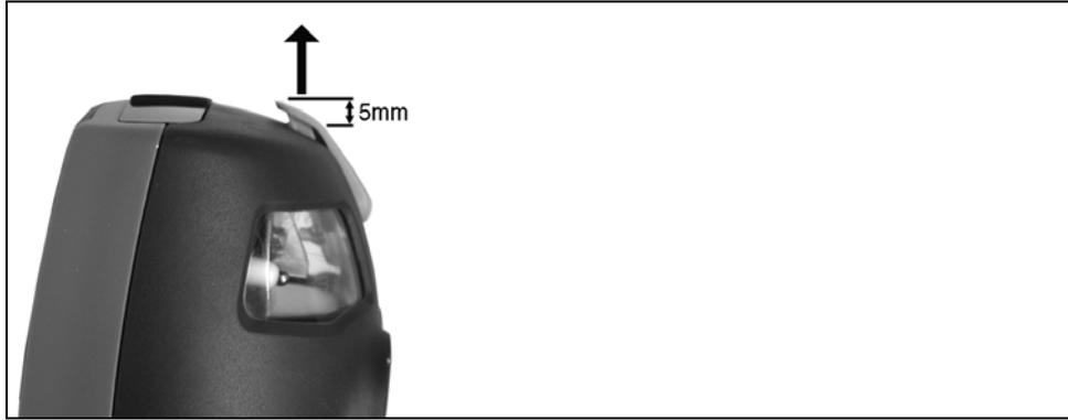
1. Desbloquee el recipiente de condensados y extráigalo horizontalmente de la caja analizadora.
