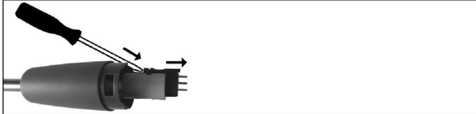
2. Con un destornillador suelte la cabeza insertable del termopar y extraiga el termopar del tubo de la sonda.
