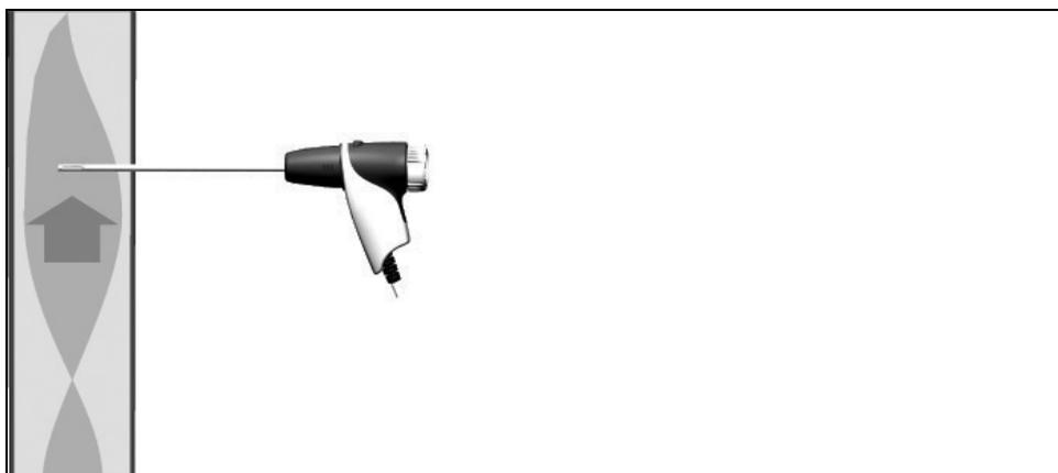
La punta de la sonda debe estar situada en el centro del flujo de los gases de combustión.
