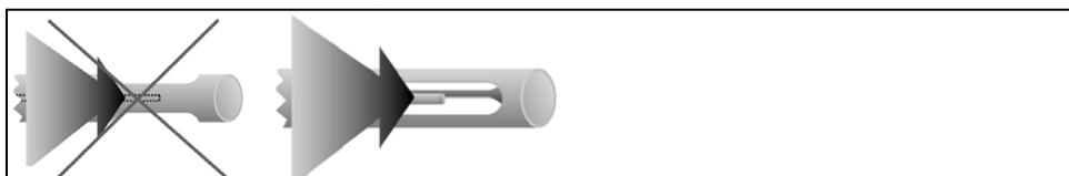
El gas de combustión debe fluir libremente por el termopar.
