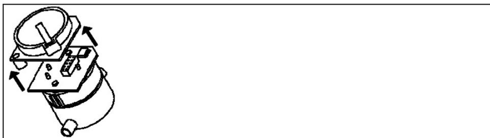
**i** La placa auxiliar del sensor no se debe retirar hasta justo antes de la instalación. No deje el sensor más de 15 min sin placa auxiliar.
